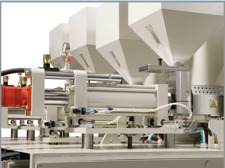
Particolare: sollevamento iniettore Particular: injector uplifting
